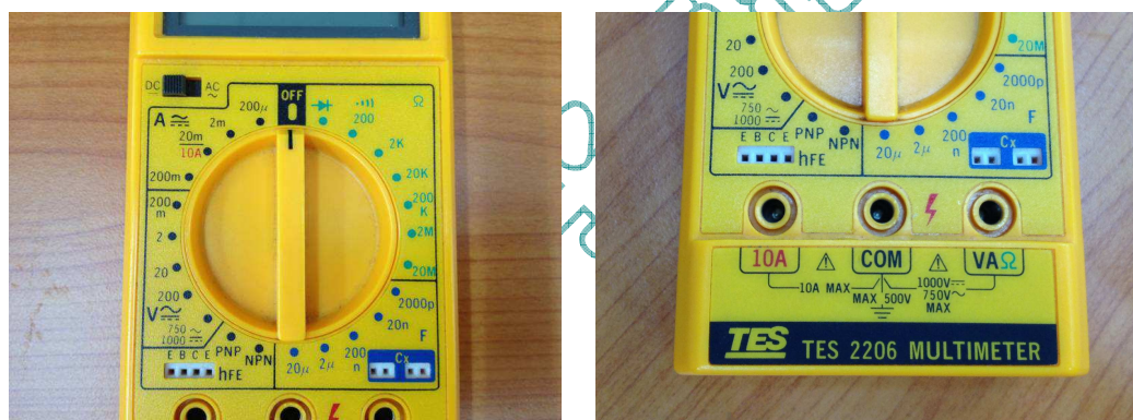
(圖 2) 功能範圍選擇開關、【10A】【COM】【VAΩ】測試插座
