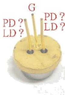
2、將三用電表，負（-）接 G，正（+）接其中一支接腳，如圖 a，然後照光（檯燈就可以了～要靠近一點！！）。量光電流（ $\sim \mu A$ ）...若是有光電流...則該接腳為 PD。
