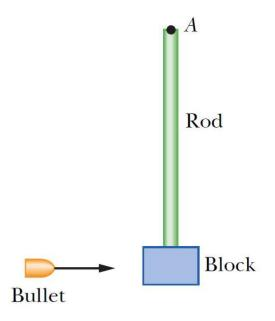
在圖中,將1.0 g子彈發射到0.50 kg塊中,該塊連接到質量為0.50 kg,0.60 m非均勻棒的末端。 然後,塊-桿-子彈系統繞A處的固定軸在圖平面中旋轉。桿子繞軸的轉動慣量為0.06 kg.m²。 將塊視為粒子。 (a),塊-桿-子彈系統圍繞點A的轉動慣量是多少? (b)如果系統在撞擊後對過A軸的轉動角速率為4.5 rad/s,子彈在撞擊前的速度是多少? (02小題)
