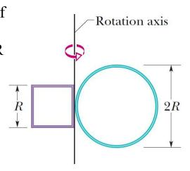
圖中顯示了一個剛體結構,該結構由半徑為R和質量m的圓環和由四個細條組成的正方形,每個細條的長度為R和質量m。 剛體繞垂直軸以恆定速度旋轉,旋轉週期為 $2.5~\mathrm{s}$ 。 假設 $R=0.50~\mathrm{m}$ 且 $m=2.0~\mathrm{kg}$ ,則計算(a)剛體圍繞旋轉軸的轉動慣量,以及(b)剛體圍繞該軸的角動量。 (02小題)
