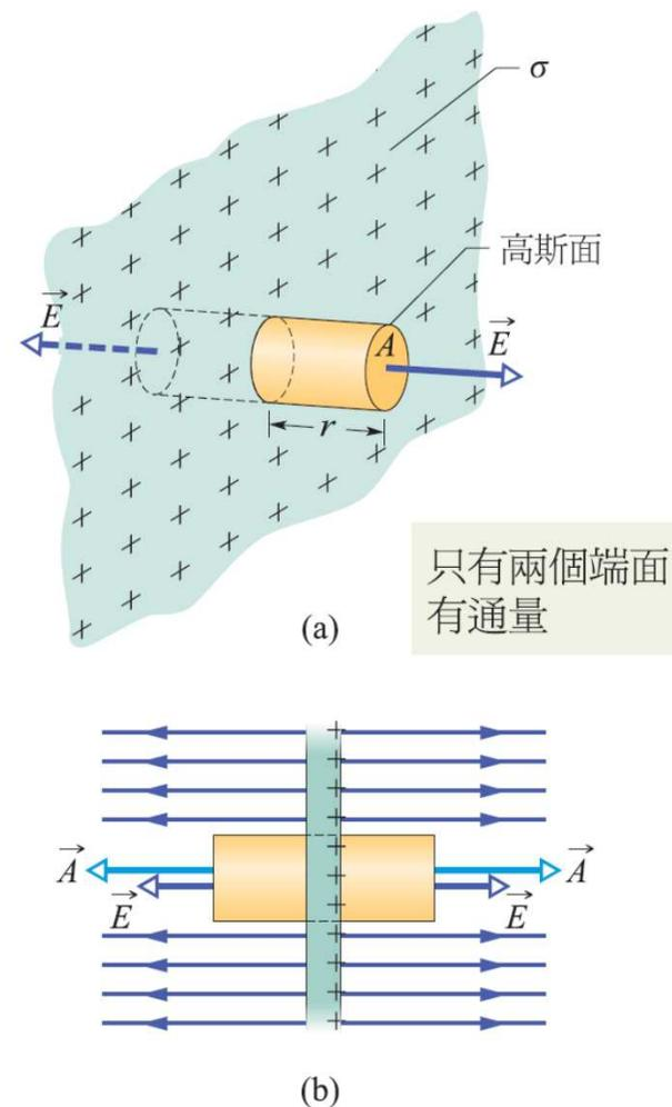
圖 23-15 一大型薄塑膠板之(a)透視圖及(b)側視圖。板的一面具有均勻面電荷 $\sigma$ 。一個封閉的圓柱高斯表面垂直通過該塑膠版。
