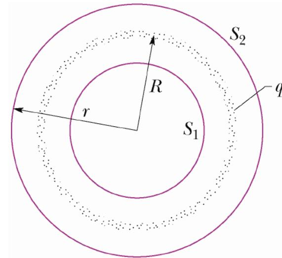
圖 23-18 帶電量  $q$  之均勻帶電薄球殼橫截面。S1 與 S2 為兩個高斯面。S2 包圍整個球殼，而 S1 僅包圍球殼內部空的部份。
