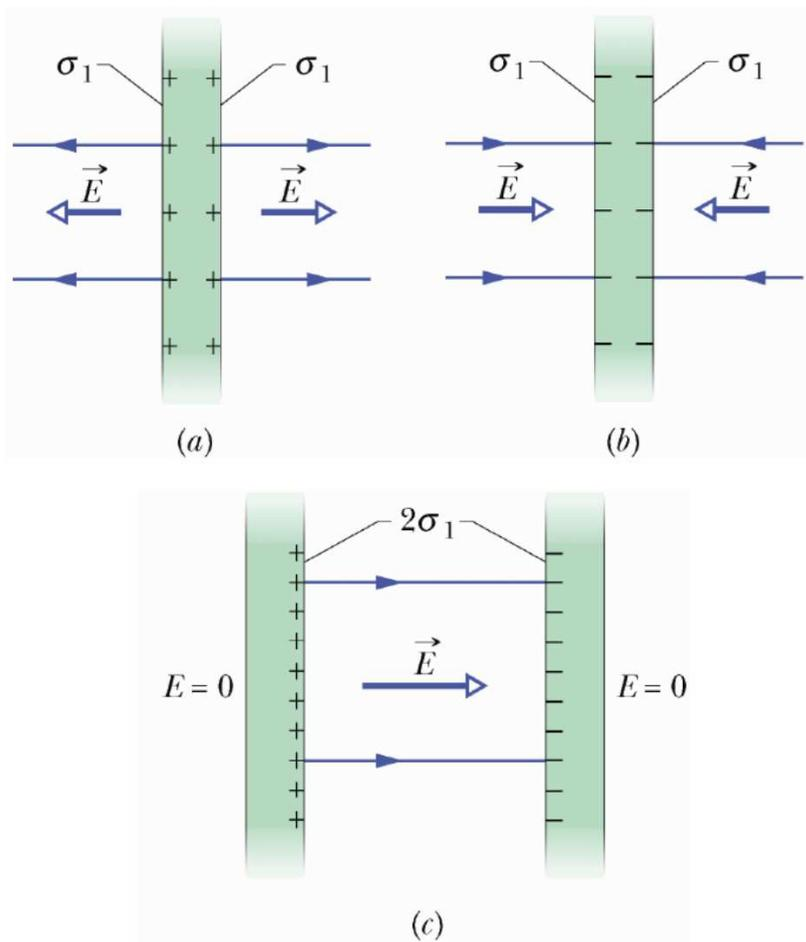
圖 23-16 (a)帶多餘正電荷的大型薄導體板。(b)帶多餘負電荷的相同平板。(c)兩平板平行且靠近。
