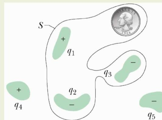
圖 23-7 五個塑膠物體均帶有電荷，及一個不帶電的銅幣。高斯面(圖示為其截面)包圍住三個塑膠物體及銅幣。
