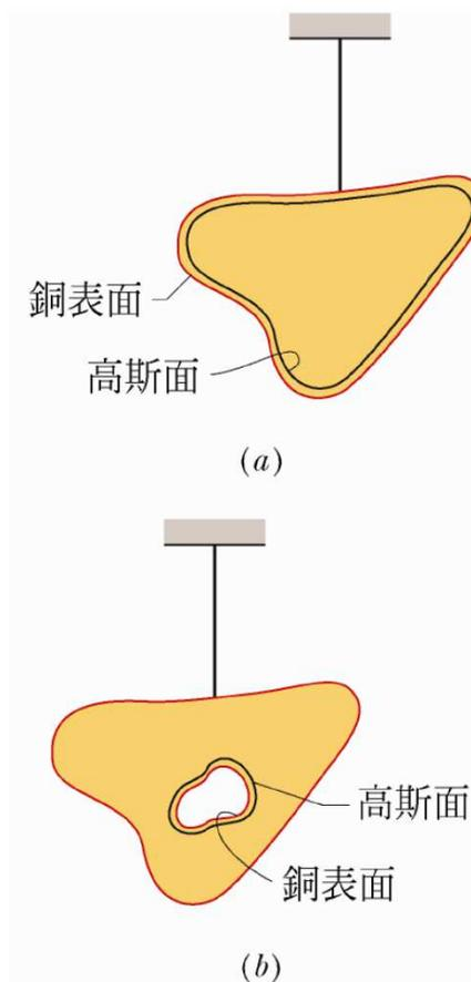
圖 23-9 (a)由絕緣線懸掛，帶電荷  $q$  之銅塊。高斯面在金屬內部，恰好位在實際表面之內。(b)銅塊內部有一空腔。高斯面在金屬內部，接近空腔表面的地方。
