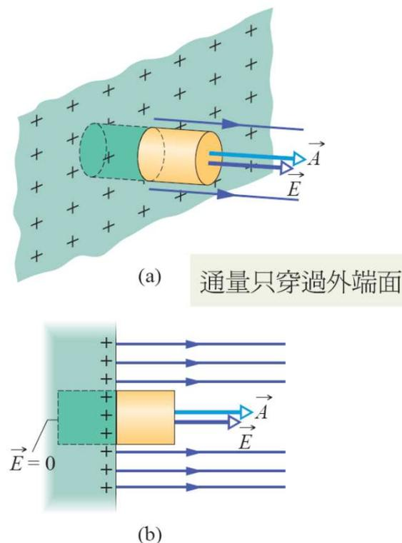
圖 23-10 表面帶有多餘正電荷的大型孤立導體的一小部份之(a)透視圖與(b)側視圖。(封閉)之圓柱形高斯面垂直地嵌入導體中，包圍了一些電荷。電場線穿過外部的圓柱端面，而不穿過內部端面。外部端面之面積為 $A$ ，面積向量為 $\vec{A}$ 。
