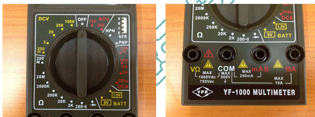
(圖 2) 功能範圍選擇開關、【VΩ】【COM】【mA】【10A】測試插座
